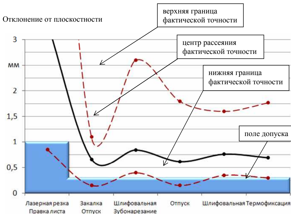
Рис. 1. Достижимая точность изготовления дисков 7555В-3502595-10 по действующему технологическому процессу
