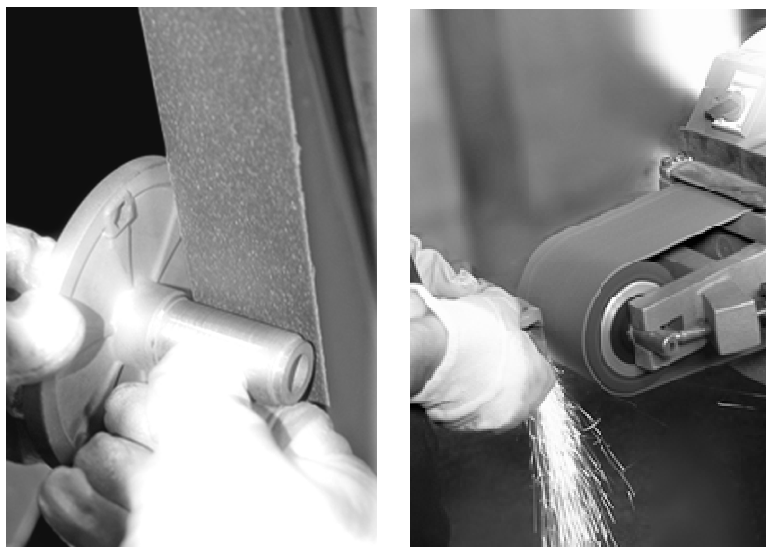
Рис. 2. Варианты отделочной обработки деталей машин эластичным шлифовальным инструментом с улучшенными эксплуатационными характеристиками
