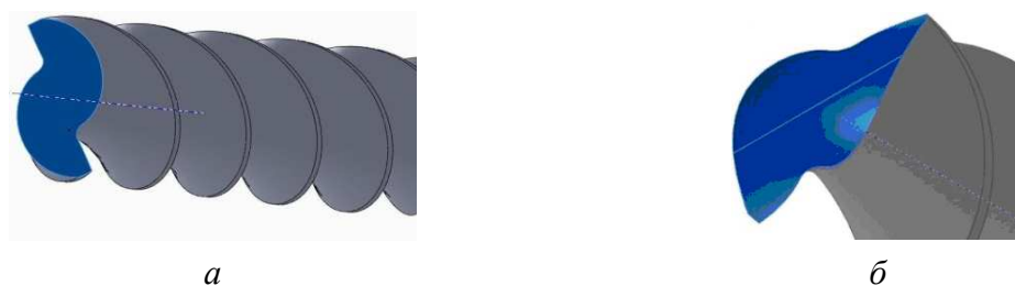
Рис. 1. Поперечное (а) и минимальное (б) сечения шнекового сверла
