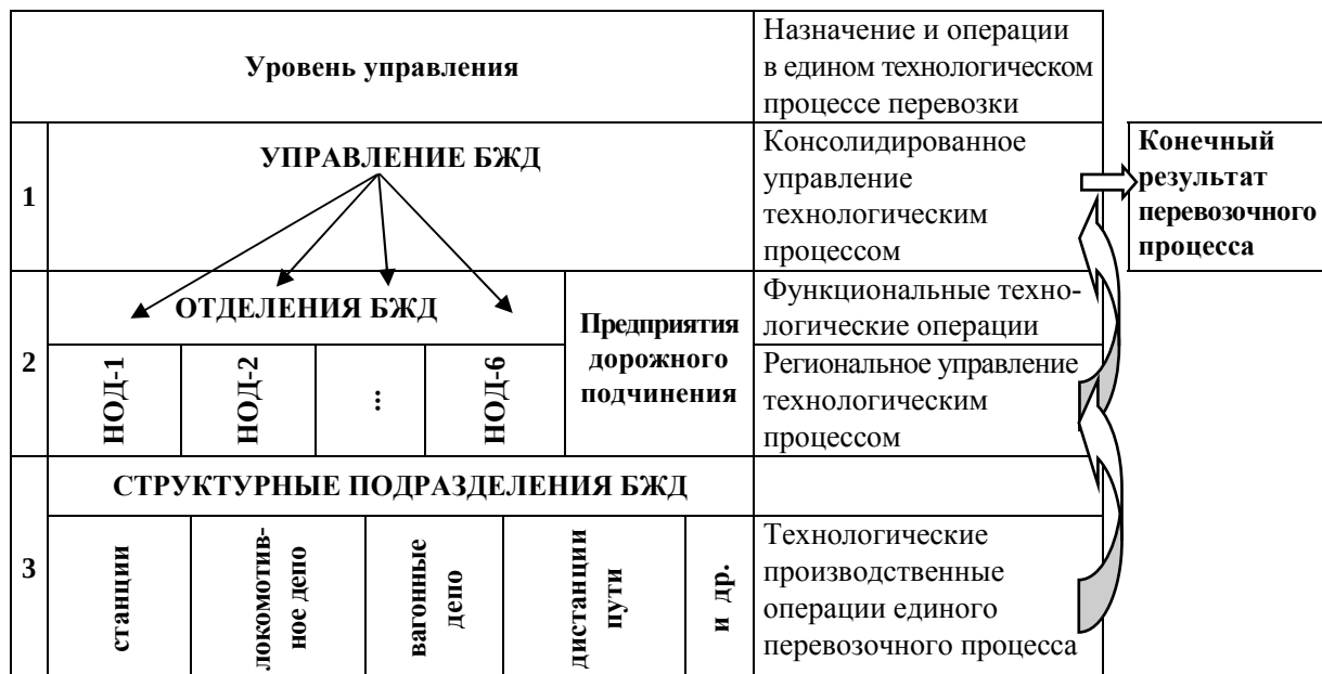
Схема взаимосвязи подразделений железной дороги в процессе осуществления единого технологического процесса перевозок
