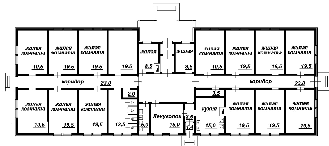
Рис. 1.21. План одного из сборно-щитовых общежитий, собранных во временном городке строителей в течение 1958 – 1959 гг. (по материалам бюро технической инвентаризации)
