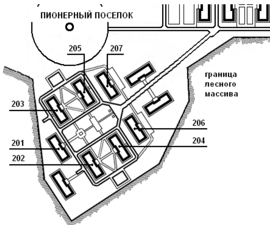
Рис. 2.76. Витебский «Облпроект». 1960 г. Схема застройки поселка Энергостроителей. 201-207 – строительные номера в соответствии с проектом застройки.
